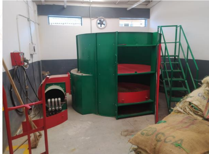
Silo a gas de capacidad 90@
